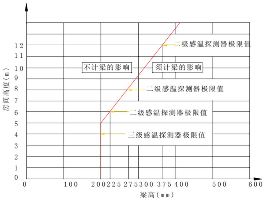
图 B 不同高度的房间梁对探测器设置的影响
