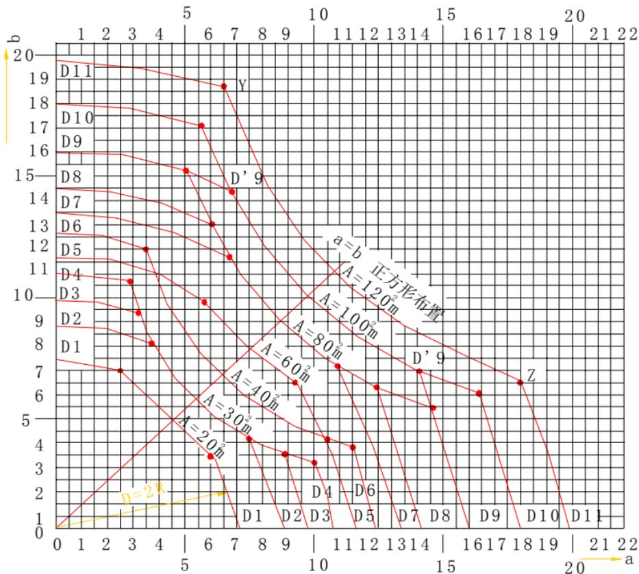
图 A 探测器安装间距的极限曲线
