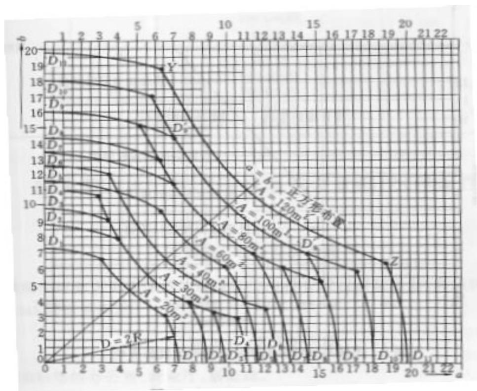
图 A 探测器安装间距的极限曲线
