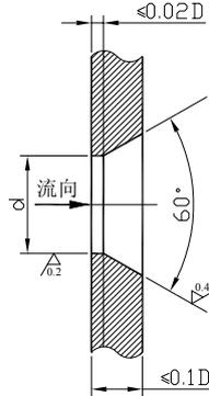
图 5 减压孔板
