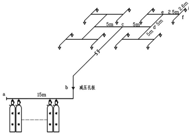
图 6 系统管网计算图
