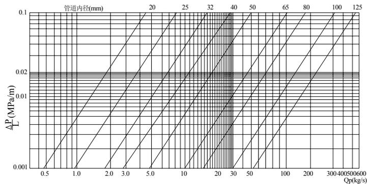
图 2 镀锌钢管阻力损失与七氟丙烷流量的关系
