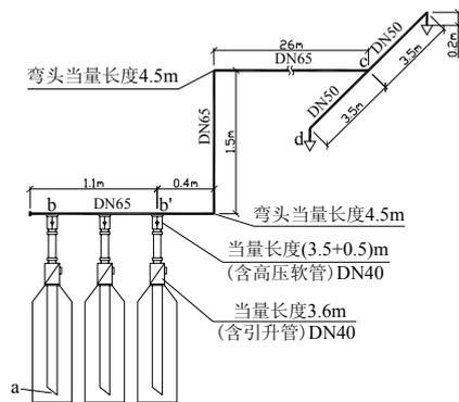
图4 系统管网计算图
